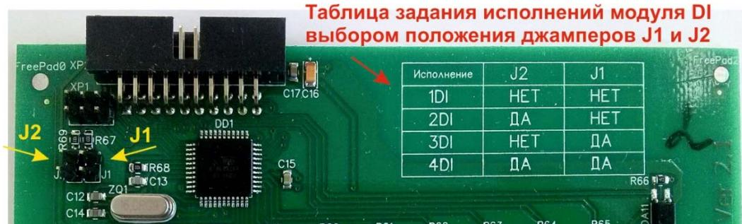
Рисунок 20 – Таблица задания исполнений модуля *DI* и места установки джамперов *J1* и *J2*
