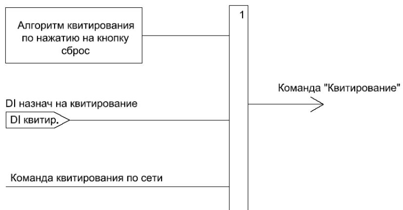
Рисунок 97 – Алгоритм работы функции квитирования
