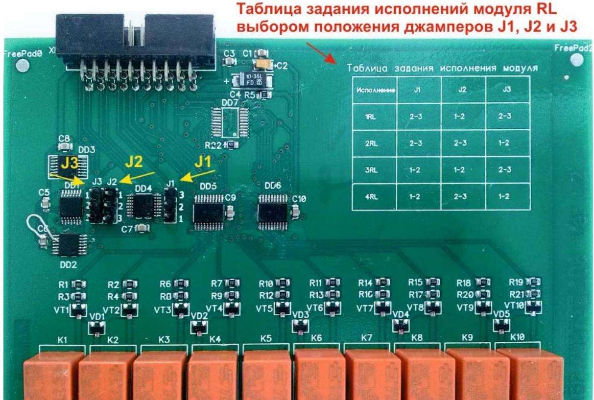
Рисунок 23 – Таблица задания исполнений модуля *RL* и места установки джамперов *J1*, *J2* и *J3*
