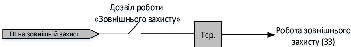
Рисунок 14 – Функціональна схема зовнішнього захисту (ЗЗ)
