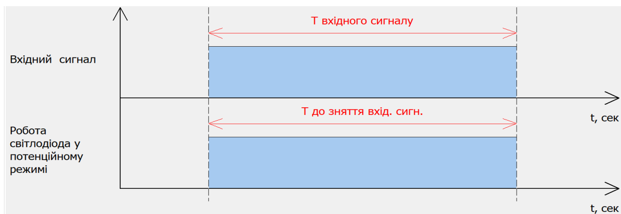
Рисунок 25 – Часова діаграма роботи світлодіодів у потенційному режимі
